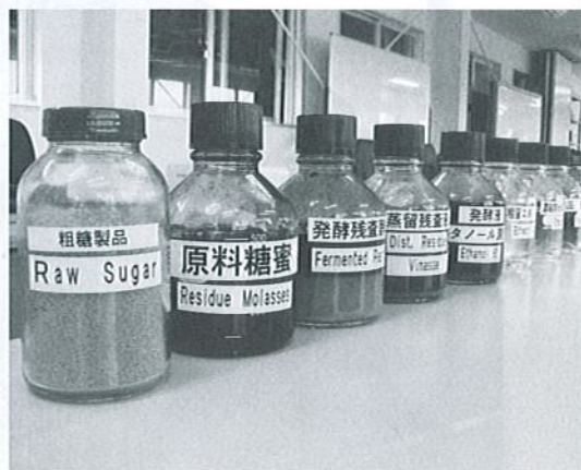
▲バイオエタノール生産工程サンプル (左から粗糖製品、糖蜜…エタノールの順)
